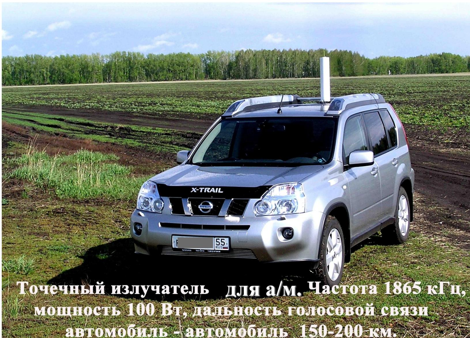
**Точечный излучатель для а/м. Частота 1865 кГц,
