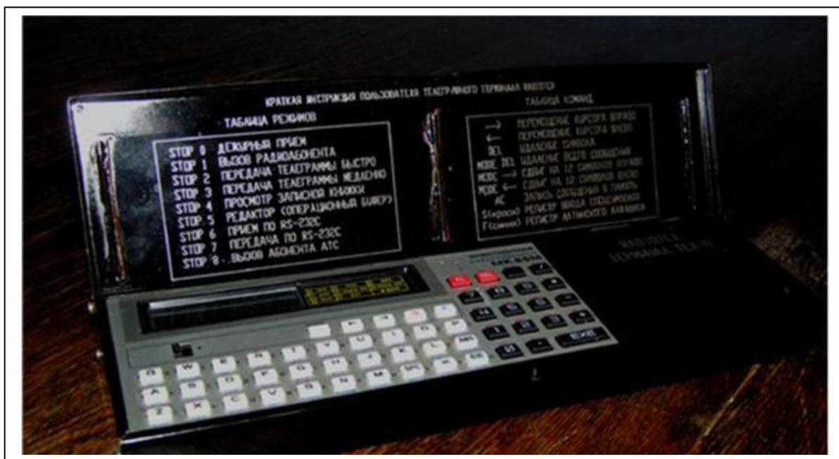
Рисунок 1. Терминал «РАДИОТЕКС» к радиостанции «КАРАТ»
